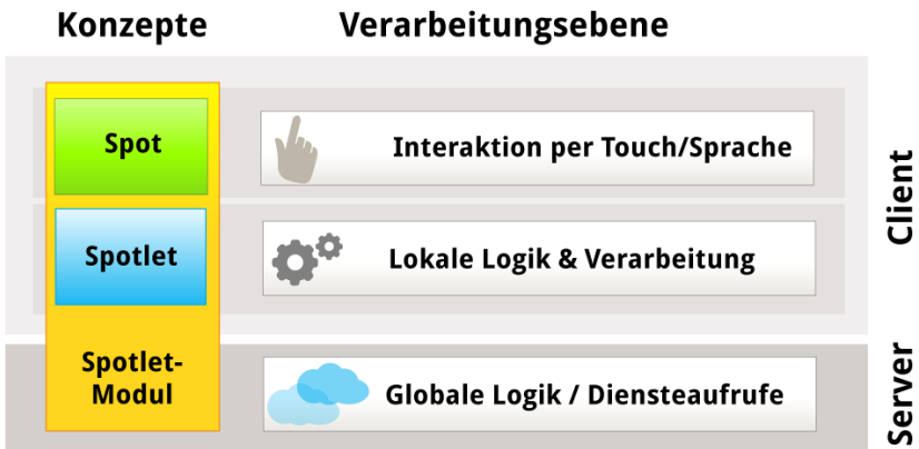
Abbildung 5.11: Prinzip und Verarbeitungsebenen eines Spotlets
